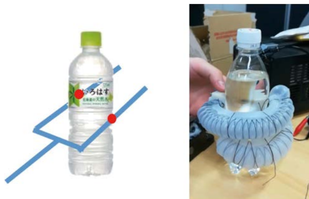
図 2-2-9 従来の硬いロボットハンド (左) とソフトロボットハンド (右: Kawasetsu et al. (in prep.))
