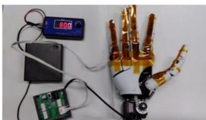
人の手型ロボットハンドへの触覚センサ実装
