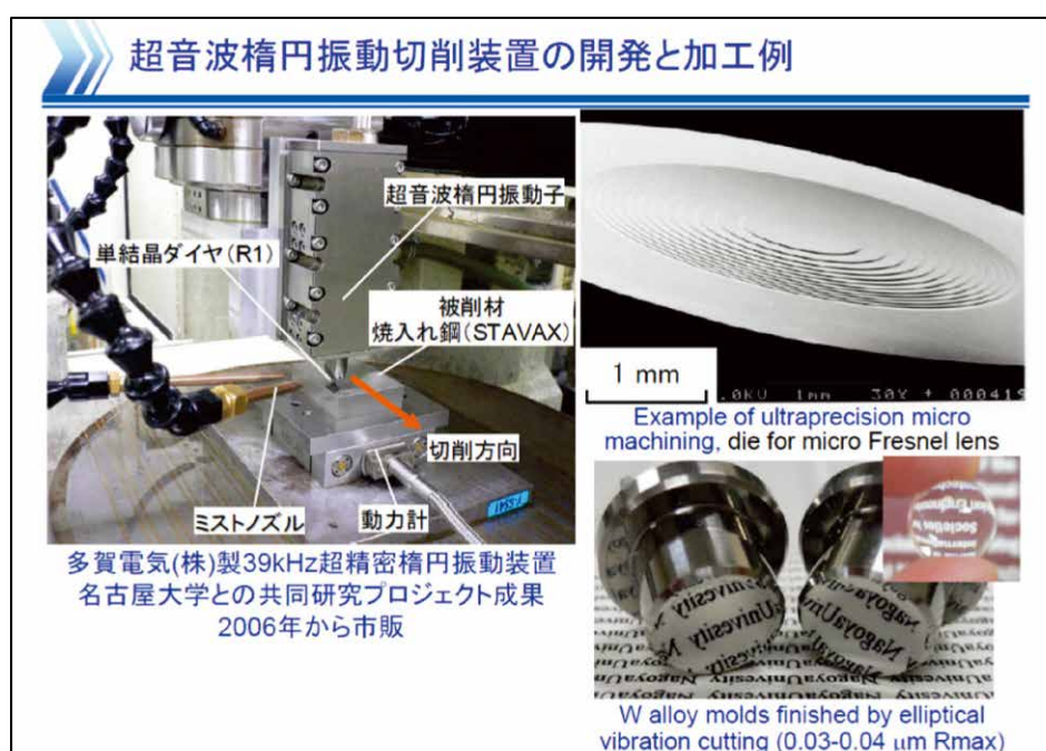
図 2-1-5 超音波楕円振動切削装置の開発と加工例
