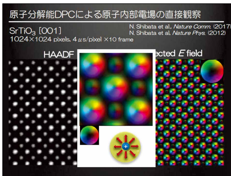
図 4-1-5 原子分解能 DPC による原子内部電場の直接観察
