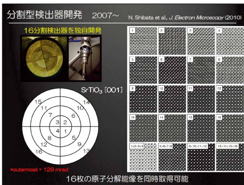
図 4-1-3 分割型検出器とそれによる原子分解能像
