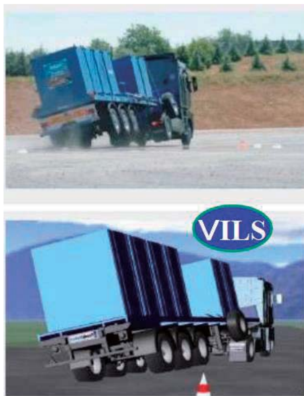
図 3-10 自動車運動性能の解析事例 (VILS: Vehicle in the loop simulation)
