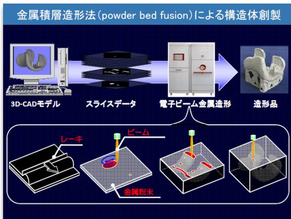
図11 金属積層造形法による構造体創製
