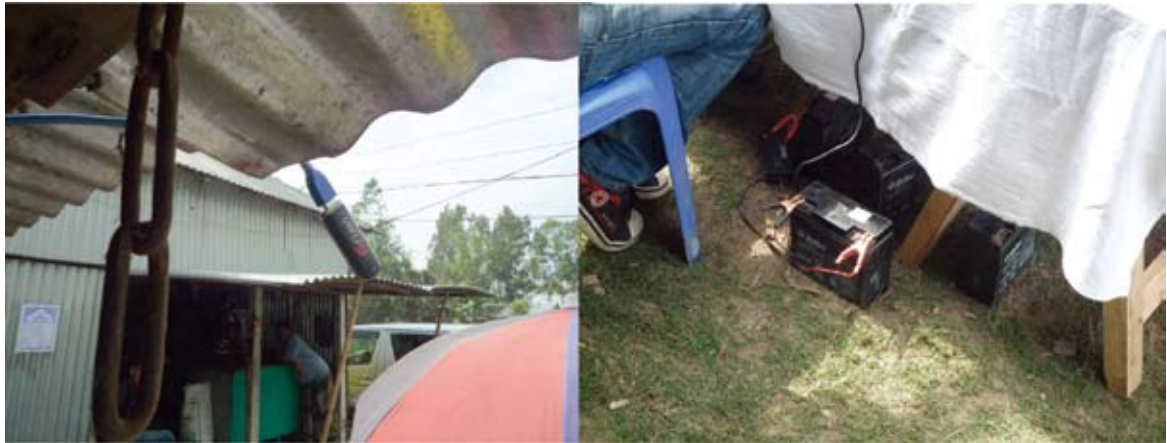
PC の USB ポートに接続した GSM モデム。電波の状態がよくないので、できるだけ高いところに上げて使う。これは屋根に引っ掛けている。
