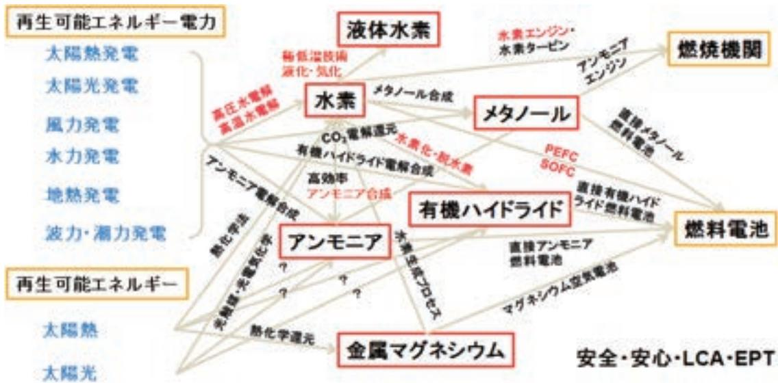
図4 様々なエネルギーキャリア間の変換 (赤字で示される変換技術は既存技術は存在するが更なる進化が必要なもの、黒字で示される変換技術は有用であるが基礎研究段階にあり、今後その実用化の可能性を探るべきものである。)
