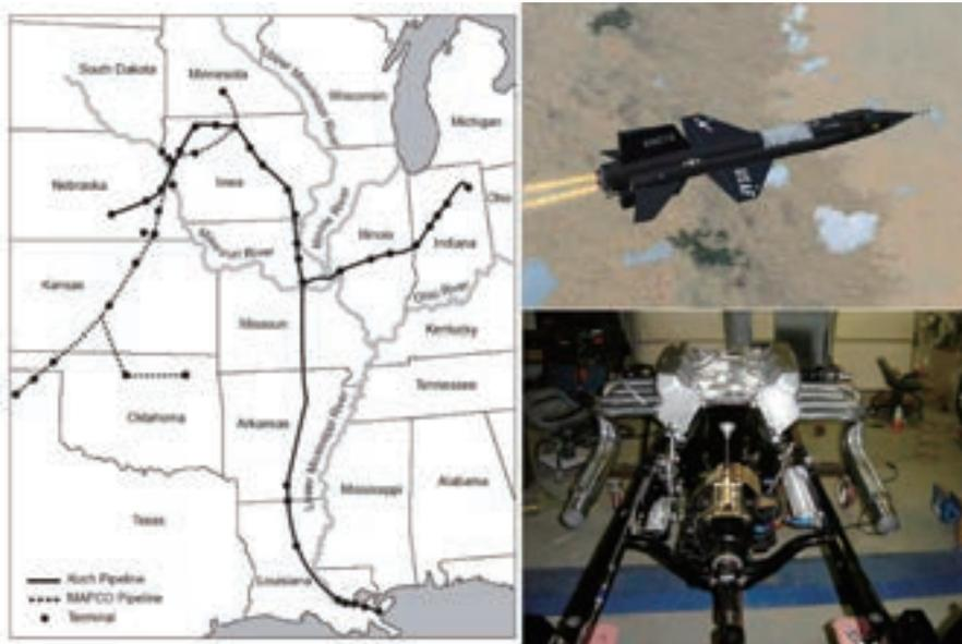
図 12 米国のアンモニアパイプライン (左図、DOE 資料)<sup>(34)</sup>、米空軍と NASA により 1959 年に開発されたアンモニアを燃料とするノースアメリカン X-15 型試作機 (右上図)、アンモニアエンジン (右下図、右上下図はアイオワエネルギーセンター資料)<sup>(35)</sup>
