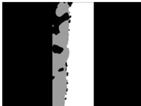
図 14 SOFC 空気極 (LSM) と電解質 (YSZ) 界面の劣化評価
