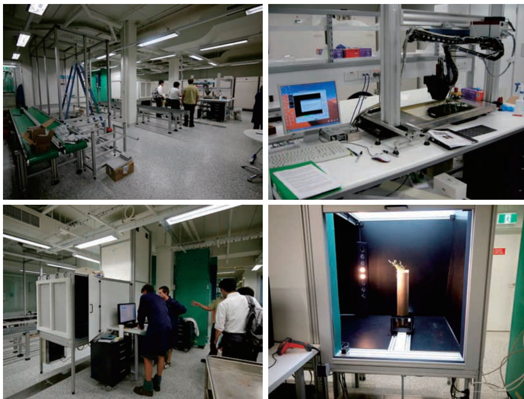
写真5 （上左）The High Resolution Plant Phenomics Centre 内の様子。手前には組み立て中だがアデレードの The Plant Accelerator と同様のベルトコンベヤが見える。部屋の奥には 10 台弱の人工気象室が並んでいる。（上右）植物体の植えられた小区画を自動で順次計測または解析する機器。（下左）アデレードの The Plant Accelerator と同様の計測設備（Renma Tec 社製）。計測デモを行なうセンター研究員（ポストドクター）。（下右）計測設備の内部。ベルトコンベヤに載った円筒形のポットが中央まで移動し、複数の角度から葉や根の形態が撮影され画像解析に用いられる。
