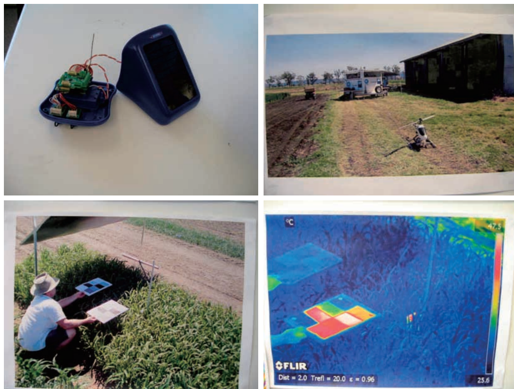
写真 6 （上左）太陽光発電駆動で携帯電話によって操作可能なデータロガー試作品。フィールドに複数設置することで便利な情報収集システムを構築できる。（上右）測定機器を搭載したヘリコプター。（下左・右）近距離リモートセンシングに関する実験風景。
