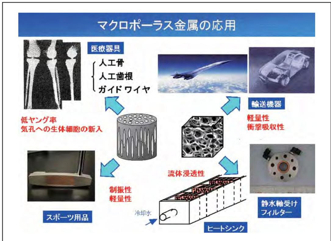
図3.3-3 マクロポーラス金属の応用
