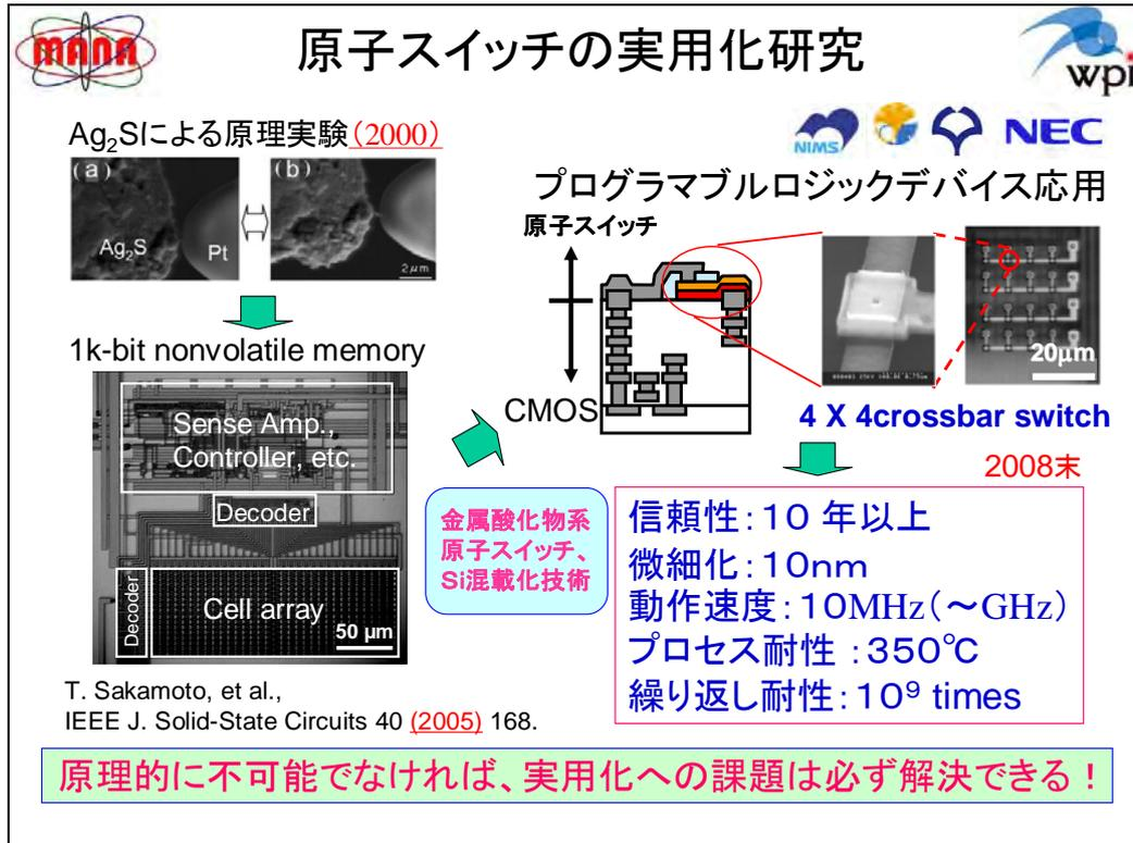
図 5.4-2 原子スイッチの実用化研究
