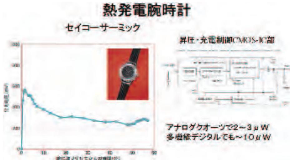
図 5.1.1 熱電発電腕時計
