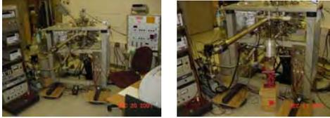
Siの研究は急速通熱(1400°Cによるフラッシング)による清浄化を行うため、スパッタクリーニングは行わない。
