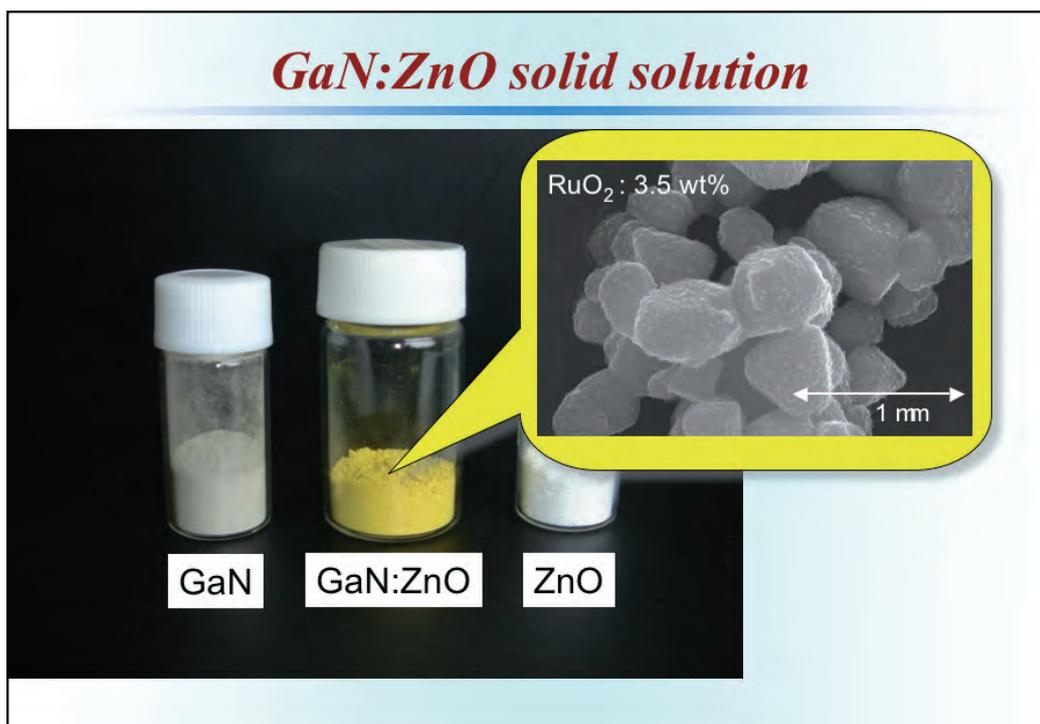
図2-5 GaN:ZnOの固溶体微粒子
