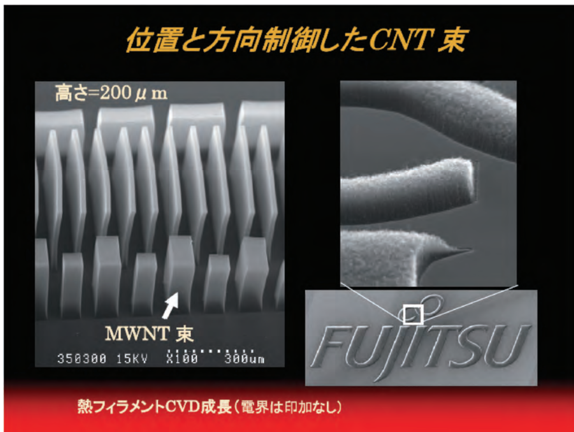
図19 熱フィラメントCVDによって制御良く成長されたCNT (栗野氏の発表スライドから)
