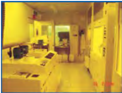
図6.2 クリーンルーム (クラス 100)
