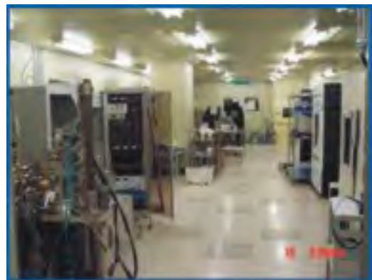
図6.3 クリーンルーム (クラス 1000)
