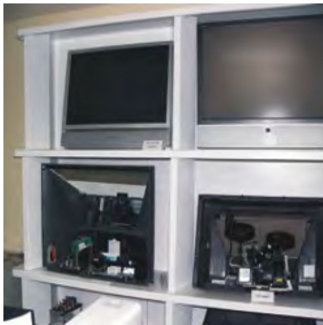
図6.7 市販プロジェクションタイプの分解例 (上段：表示部，中段：投射ユニット部，下段：電源部)
