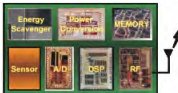
図2.6 センサーノード機能の集積 (MIT プレゼン資料より)
