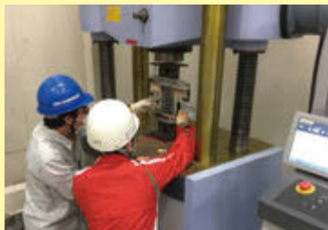
引張圧縮試験機に試験体を装着：島根大学
