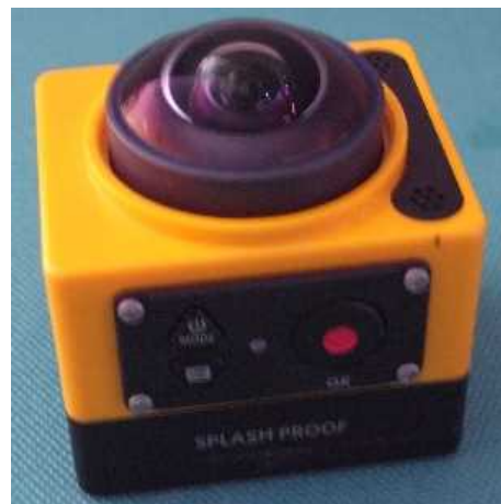
図2 360 視野カメラ (PIXPRO SP360 Kodak)
