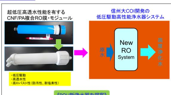
図：超低圧・高透水性ROモジュールを使った新しい浄水器の提案
