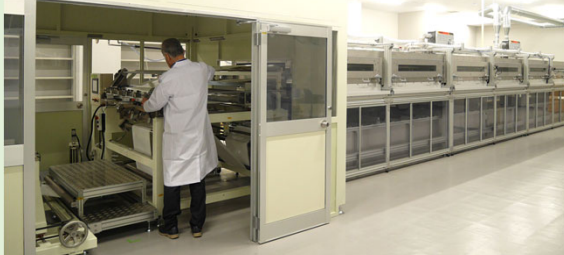
4インチモジュール用に70m長の連続製膜が可能な大型製膜装置
