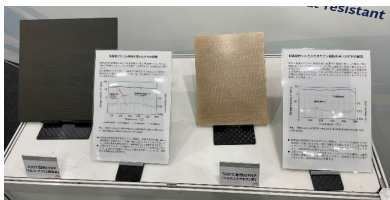
SAMPE Japan先端材料技術展2021における展示 (左:250℃耐熱CFRP 右:500℃耐熱GFRP)
