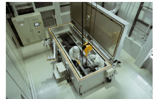
デッドウェイトによる荷重準備状況
