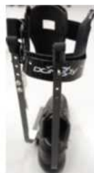
(a) 2020 年型 CFRP バネ装具。CFRP バネ搭載位置を最適化した結果、歩行および重量物運搬時の支援効率が向上した。靴とあわせて 1kg 未満を達成した。下肢接続部は写真の装置の場合はジュラルミンを使用しているが、フレームを CFRP で作成した装具も開発中である。
