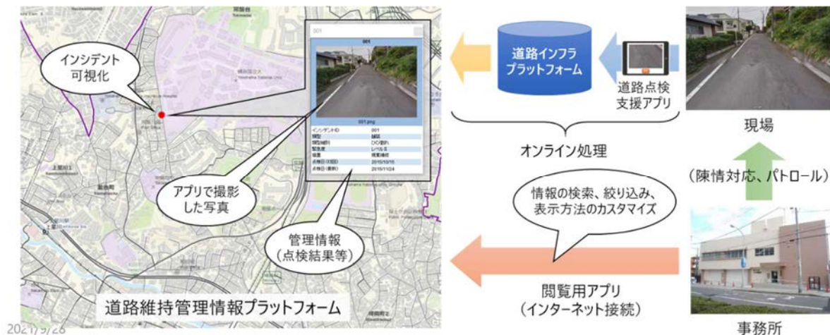
図 4.2.3.2 道路点検支援システムの構成
