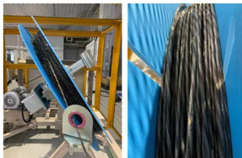
図 4.1-2 開発した FRP ロッド巻取機
