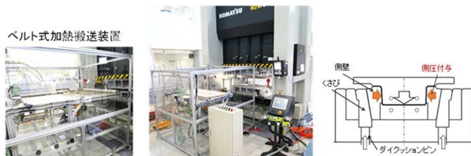
図 4.9-4 ベルト式加熱搬送装置と側圧付与機構金型の断面図
