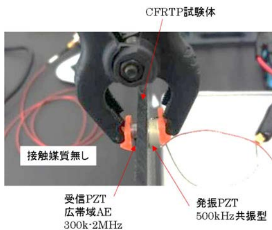
図 4.9-8 電磁超音波共振法の測定構成の写真
