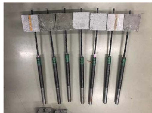
図 4-5-7 引抜き供試体の様子
