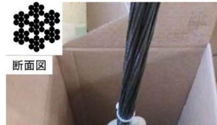
図 4-5-2 FRTP の外観の様子
