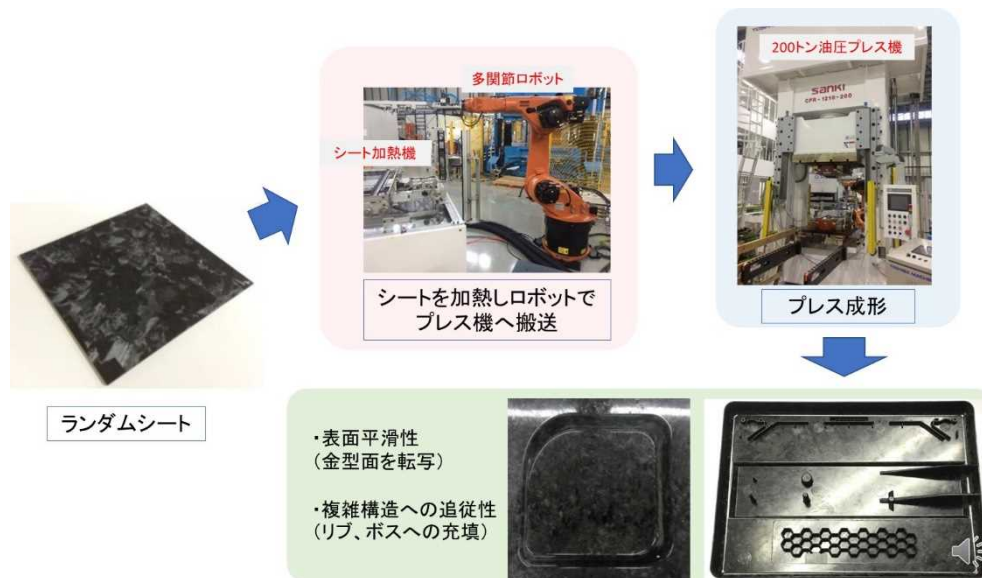
図 4.11-3 ランダムシートからの複雑形状部材のプレス成形技術
