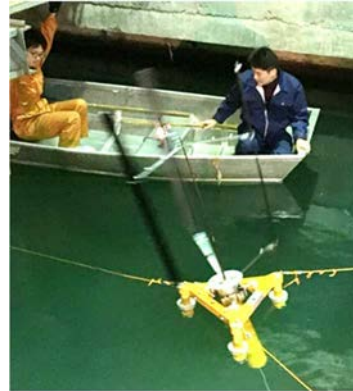
図 4.6-5 動力取出機構モデル(金沢工業大学)と水槽試験(大阪大学)
