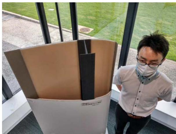
図 4.6-8 連続成形を想定した風車ブレード断面モデル
