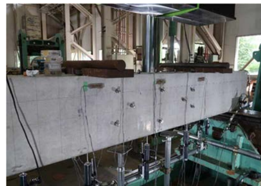
図 4-5-10 耐荷性能試験の様子
