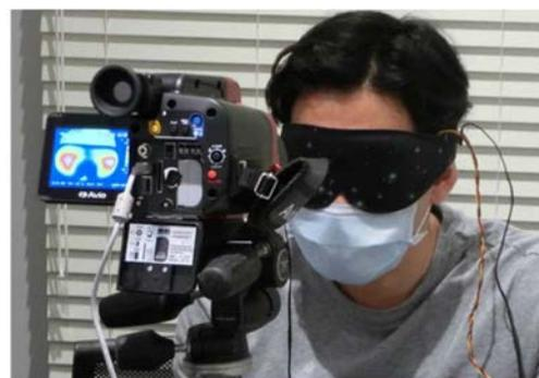
図4.4.2 アイマスクプロト機を用いた皮膚表面温度計測
