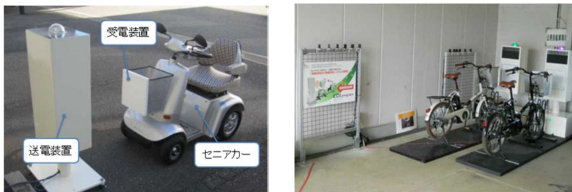
図 5 試作した無線給電システム(セニアカー用)と精華町での実証実験に用いた無線給電システム(電動自転車用、2 台分)
