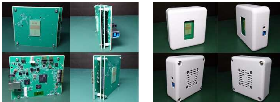
図2 試作レーダの内部基板（左）および筐体外観（右）
