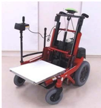
屋外を移動する土台部
