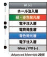
塗布型白色リン光 マルチフォトン有機 ELの開発に成功 (9層塗布)
