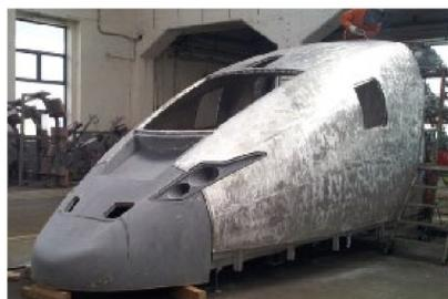
図5. 高速鉄道車両 (軽量・衝撃吸収)
