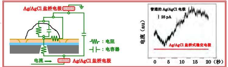
铺设在硅单晶基质上细胞外基质，固定在这个细胞外基质的上面神经元，测量通过离子通道的电流。
