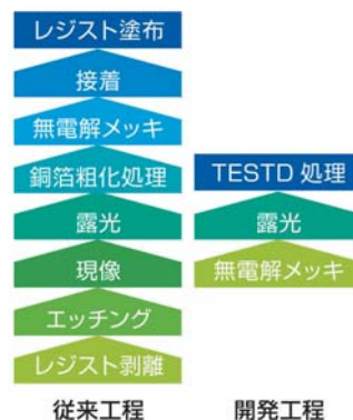
図2 プリント回路基板の片面の工程
