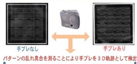
本システムによる手ブレ検出・補正効果の評価例
