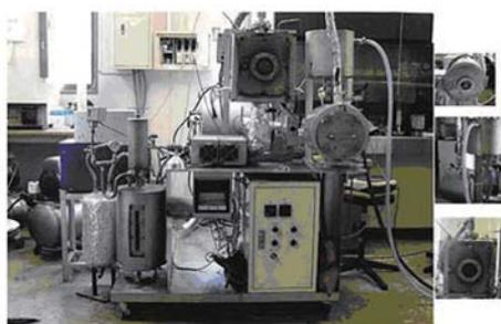
『過熱水蒸気発生装置』
