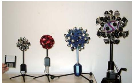
『全方向ステレオカメラシステム ASTRO Sensor Series』全方向のカラー画像と3次元情報をリアルタイムに取得可能な世界初のシステム。空間における動的イベントの理解や監視、テレプレゼンス、移動体ビジョン等多くの分野で応用でき、従来避けられなかった「画角の制限」を完全に排除し、死角のない広い視野を実現可能。
