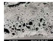
ヘドロセラミックスの断面
