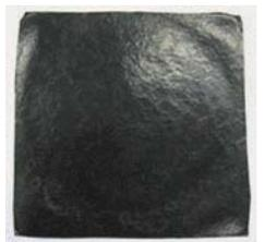
CNCを用いた電磁波吸収体
