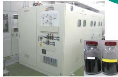
CNC合成試験装置とCNC合成物
