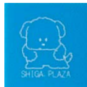
CO 2 /N 2 含浸プラスチック材料へのレーザー印字例
