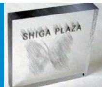
CO 2 /N 2 含浸プラスチック材料へのレーザー印字例
