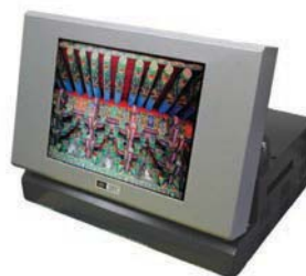
試作した15型フィールドシーケンシャル法OCBカラー液晶ディスプレイ
