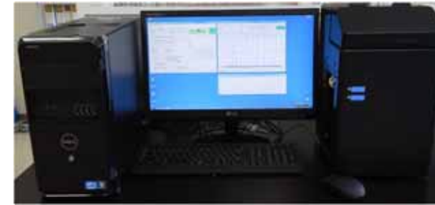
図1 試作装置の外観 蛍光標識した抗体でウイルス・細菌を検出 検出感度 10^3 \sim 10^4 個/ml (20~200 粒子)
