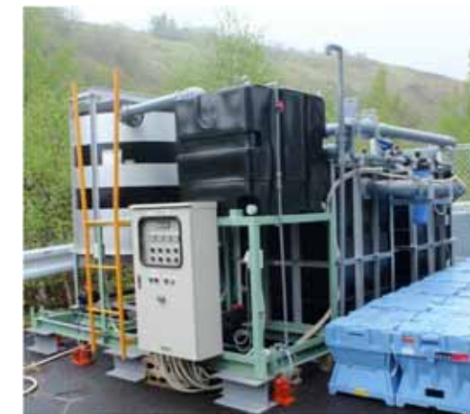
図2 廃坑廃水を対象にしたヒ素除去用吸着装置
