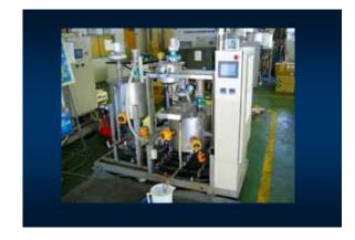
図6 製品化に向け試作した加熱型実証実験装置
