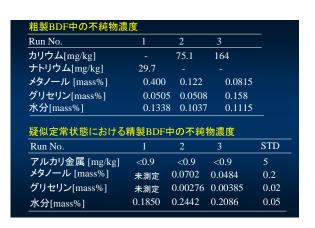
図5 電場型連続精製装置による連続精製実験結果の例
