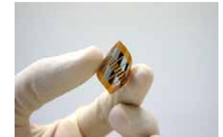
図3 フレキシブル基板に印刷した熱電モジュール
