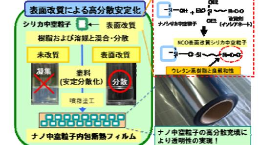
図2 表面改質技術によるナノシリカ中空粒子の高分散充填により断熱フィルムに高い透明性を実現
