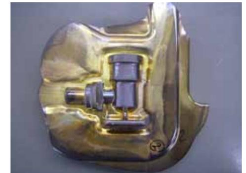
図3. 熱間鍛造加工による開発黄銅粉末合金からの3次元複雑形状部品の試作結果
