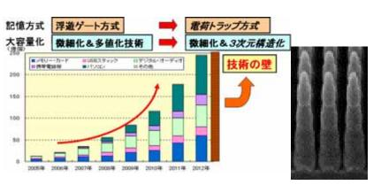
不揮発性半導体メモリの市場予測と、その 積層縦型構造不揮発性 本育成研究で開発する製造技術課題 半導体メモリの試作例 技術の対象である電荷蓄積
