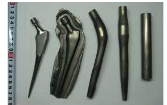
図4 室温での型鍛造、熱処理、5軸マシニング加工により作製したステム外観
