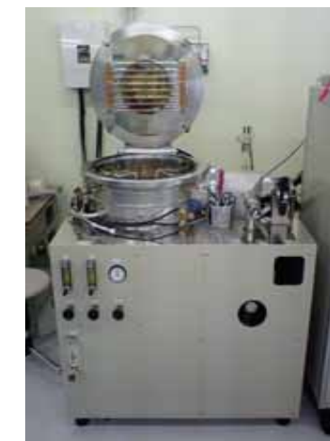
図 4 本研究で開発した 8 インチ高速アニール装置本体写真
