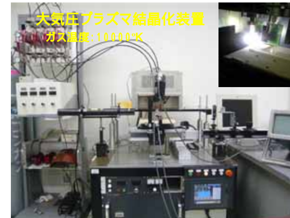
図1 プラズマ結晶化装置の概要とプラズマ発光
