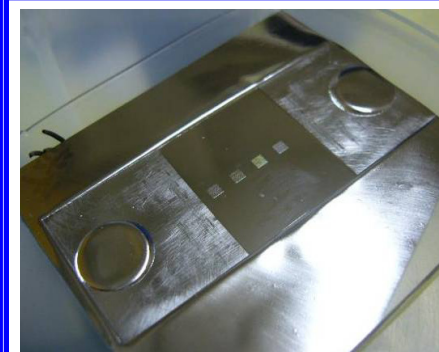
〔ナノインプリントリソグラフィにより複製した標準面実量器〕
