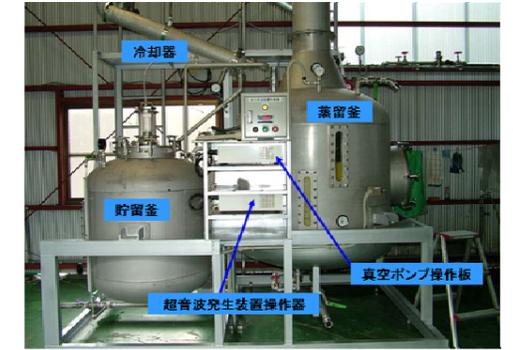
図2 超音波印加型減圧水蒸気蒸留装置
